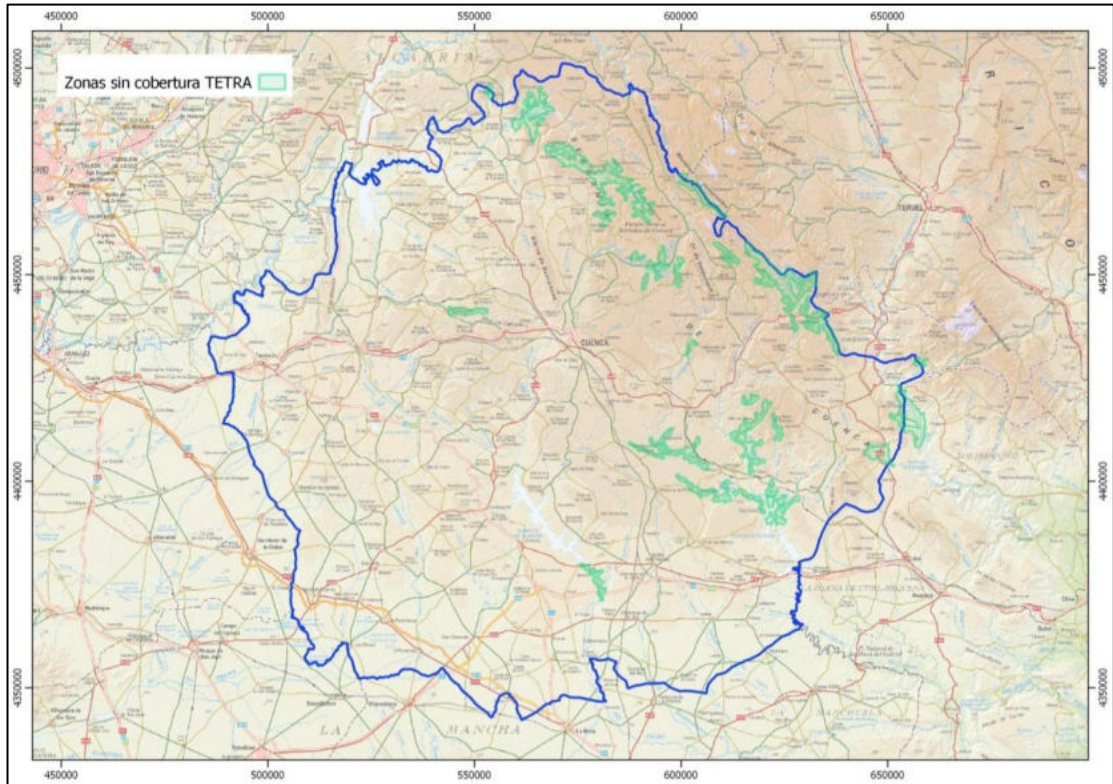
Figura 33. Zonas sin cobertura TETRA en la provincia de Cuenca.
